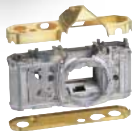
Cuerpo moldeado a presión, elaborado con una aleación de cobre, siluminio y aluminio. Tapas superior e inferior de latón.
